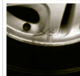
EXCESSIVE : enjoliveur endommagé
