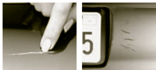
EXCESSIVE : peinture égratignée
