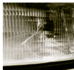
EXCESSIVE : feu arrière fissuré
