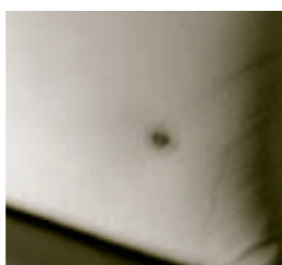
EXCESSIVE : brûlure en surface
