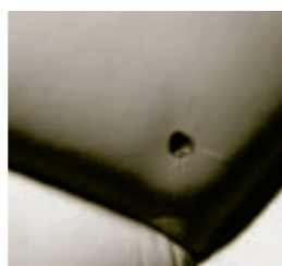
EXCESSIVE : brûlure en profondeur
